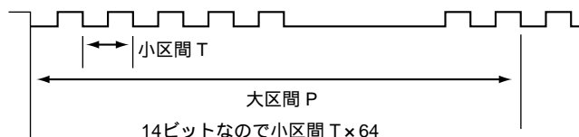
図 4-25 14 ビットパルスジェネレータ
